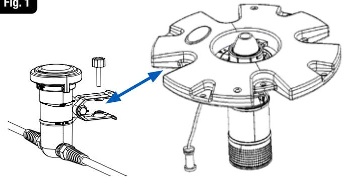
**Installation du jeu d'éclairage LED Airmax sur un système de flotteur ISP**
