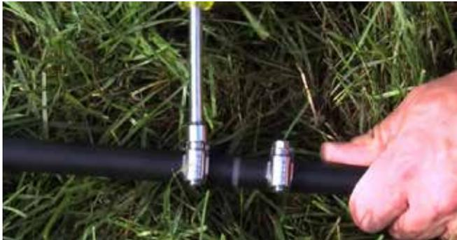
Desenrollar la línea aérea EasySet ponderada y eliminar cualquier torcedura o giros. Únete suficientes secciones de línea aérea ponderada, utilizando 5/8" kits de conectores, de modo que la línea aérea puede descansar en el fondo del estanque, desde el borde del estanque a la ubicación prevista para cada difusor. Para las instalaciones de la opción B, conecte la línea aérea ponderada de la línea aérea subterránea directa o kit alejado del colector en la orilla del estanque.
